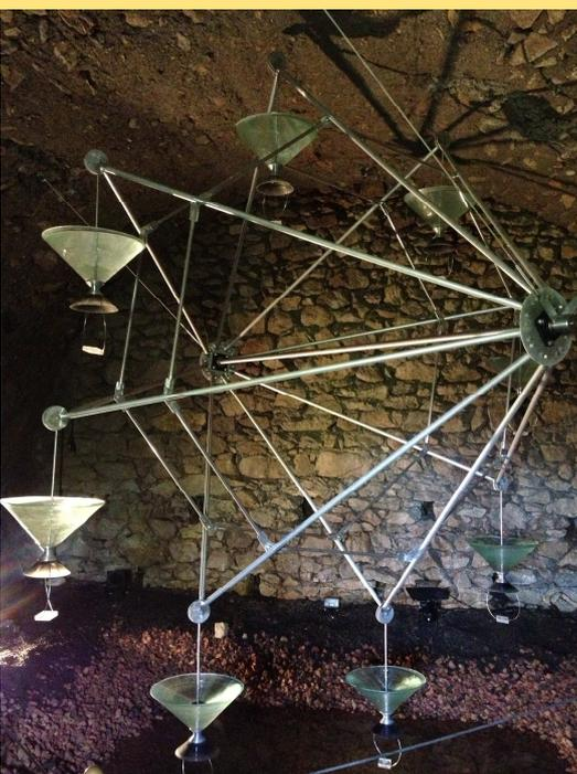
A l'intérieur, un mécanisme ingénieux permet de faire tourner une roue : des coupelles se remplissent d'eau et impriment un mouvement. En-dessous de chaque coupelle, on allume une mèche, qui, comme par magie, s'éteint d'elle-même, à la fin de la révolution de la roue.
